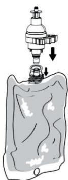
REMOVE THE PROTECTIVE CAP FROM THE SOAP REFILL BAG AND INSERT THE PUMP INTO THE SOAP BAG.
