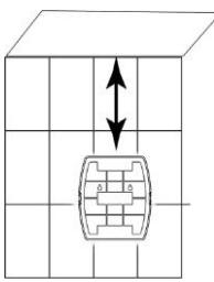
RECOMMENDED MOUNTING HEIGHT AT LEAST MIN 100 MM FROM THE CEILING.
