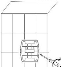
PLACE THE DISPENSER BACK ON THE WALL AND TIGHTEN THE SCREWS.
