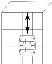
RECOMMENDED MOUNTING HEIGHT AT LEAST MIN 100 MM FROM THE CEILING.
